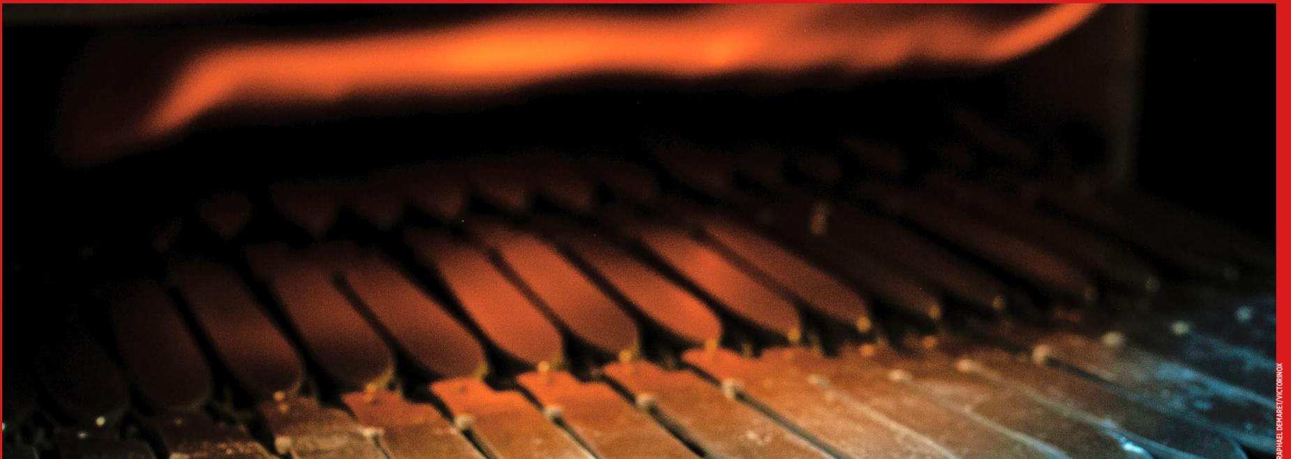
**Härteofen:** Bei einer Temperatur von über 1000 Grad Celsius werden die Stahlklingen gehärtet. Dieser Fertigungsprozess wird für alle Taschen- und Haushaltsmesser eingesetzt, etwa auch beim Modell Rescue Tool.
